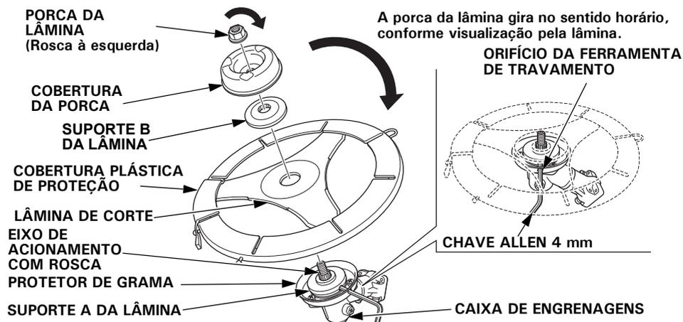
4. A instalação pode ser efetuada na ordem inversa da remoção. Certifique-se de instalar a lâmina com a borda de corte no sentido de rotação. Aperte a porca da lâmina com: **24,0 N.m (2,5 kgf.m)**
