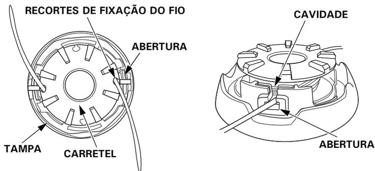
8. Alinhe a abertura da tampa com a abertura na carcaça, e instale a tampa na carcaça.
