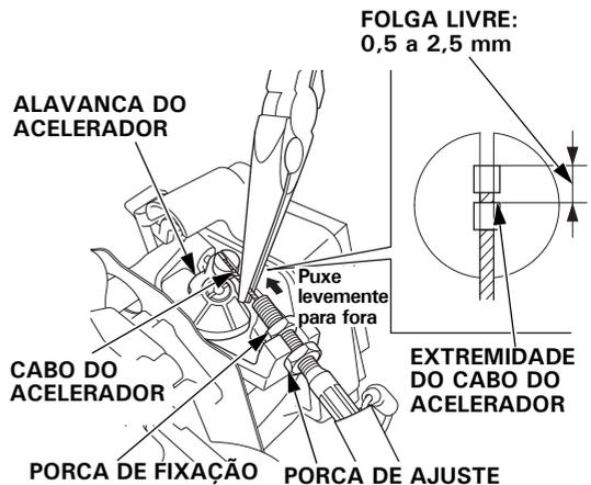
5. Aperte firmemente a porca de fixação do cabo do acelerador.
