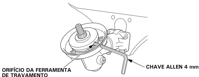
2. Gire o conjunto do cabeçote de corte no sentido anti-horário para fazer a instalação na caixa de engrenagens.
