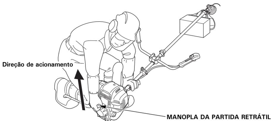
5. Se a alavanca do afogador for movida para a posição FECHADA para acionar o motor, mova-a gradualmente para a posição ABERTA, conforme o motor se aquecer.
