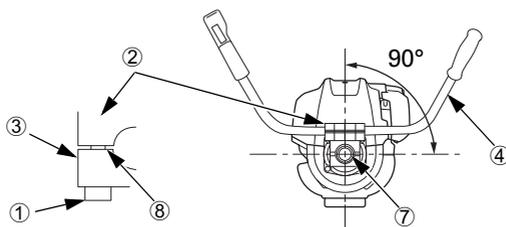
4. Ajuste o guidão ④ de maneira que forme um ângulo reto com o tubo do chassi ⑦ visualizando o guidão ④ pela lateral. Após o ajuste, aperte os parafusos Allen de 6 x 30 mm ⑥ com o torque especificado.
