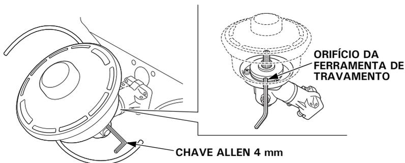
3. Gire o cabeçote de corte com fio de náilon no sentido horário para removê-lo da caixa de engrenagens. Faça a substituição por um novo.
