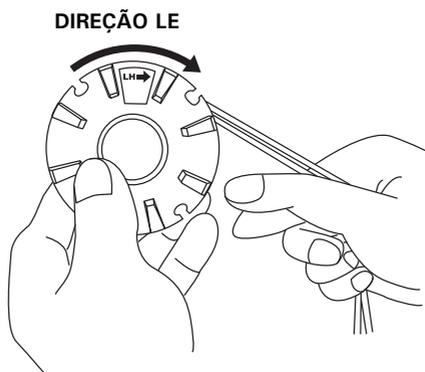
6. Prenda os fios de náilon nos recortes de fixação do fio no flange externo do carretel. Deixe 10 cm dos fios passando pelos recortes. Não deixe que os fios afrouxem.
