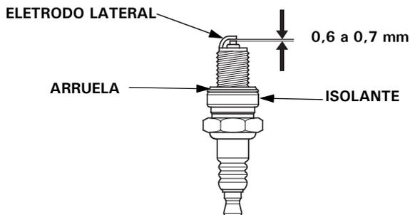
5. Verifique se a arruela da vela de ignição está em boas condições e rosqueie manualmente a vela de ignição para evitar danos à rosca.
