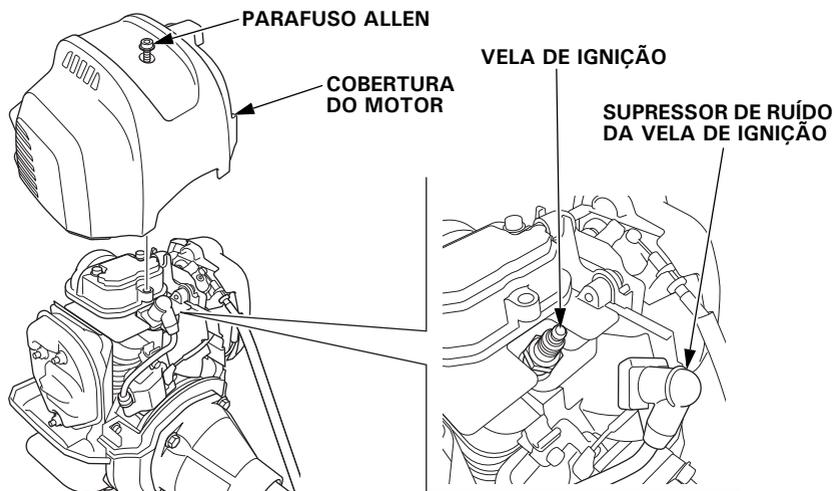
3. Inspeccione visualmente a vela de ignição. Descarte a vela se os eletrodos estiverem gastos ou se o isolante estiver trincado ou lascado. Limpe a vela de ignição com uma escova de aço caso a reutilize.
