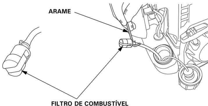
4. Inspeção o filtro de combustível quanto à sujeira. Se o filtro de combustível estiver sujo, limpe-o suavemente com solvente não inflamável. Se o filtro de combustível estiver muito sujo, substitua-o.
