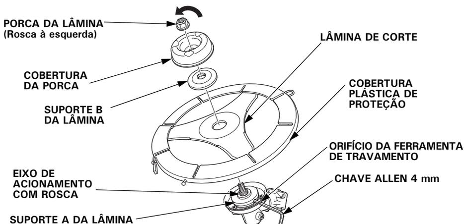
5. Depois de apertar a porca da lâmina, gire a lâmina de corte com a mão e verifique se ela está instalada corretamente no centro. Certifique-se também de que a lâmina de corte não esteja excêntrica nem interfira em qualquer peça próxima.
