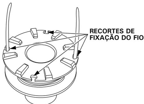
7. Encaixe o carretel na tampa em uma posição que alinhe os recortes de fixação do fio com as aberturas na tampa. Passe os fios de náilon pelas cavidades nas aberturas da tampa, parte superior das aberturas.
