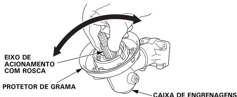
Depois de executar o procedimento "Limpeza da caixa de engrenagens", e "Inspeção do eixo de acionamento com rosca", certifique-se de montar o suporte A da lâmina na caixa de engrenagens antes de fixar o acessório de corte. Para fixar o acessório de corte, consulte as páginas 61 e 66.
