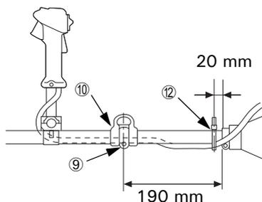
7. Encaixe o cabo do acelerador firmemente no suporte ⑩.
