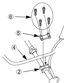
3. Ajuste o guidão ④ de maneira que forme um ângulo reto com a linha central do tubo do chassi ⑦ visualizando o guidão ④ pela lateral da caixa de engrenagens.
